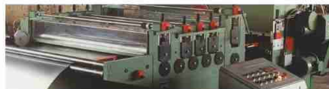
TAGLIO LONGITUDINALE E TRASVERSALE CON RIAVVOLGIMENTO DI UNA PARTE DEL NASTRO
