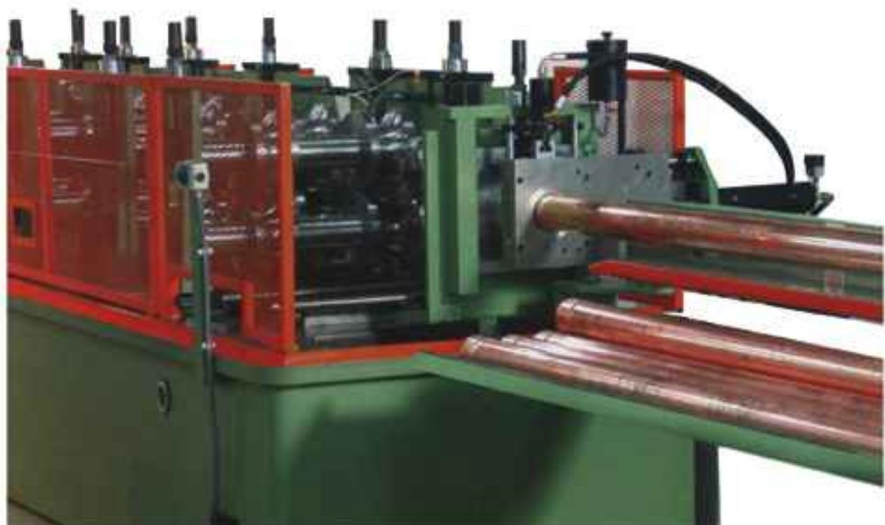
Ligne di profilatura per tubi pluviali
